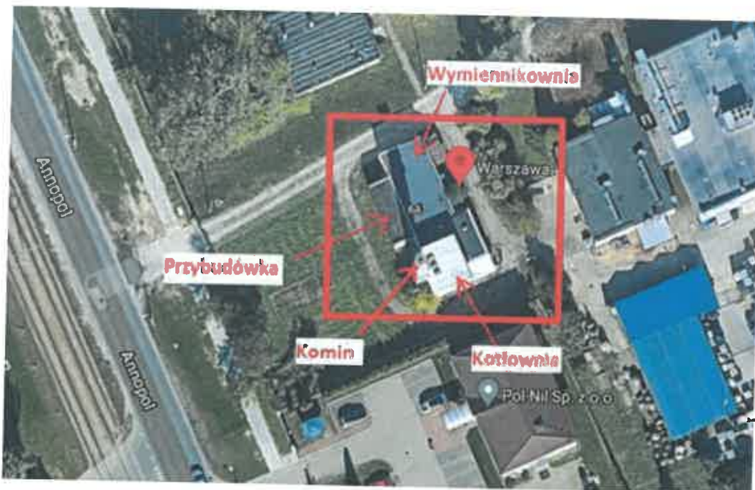
Rys. 3.2 Poszczególne segmenty budynku 19 wraz z ich oznaczeniem (źródło Google Maps).
